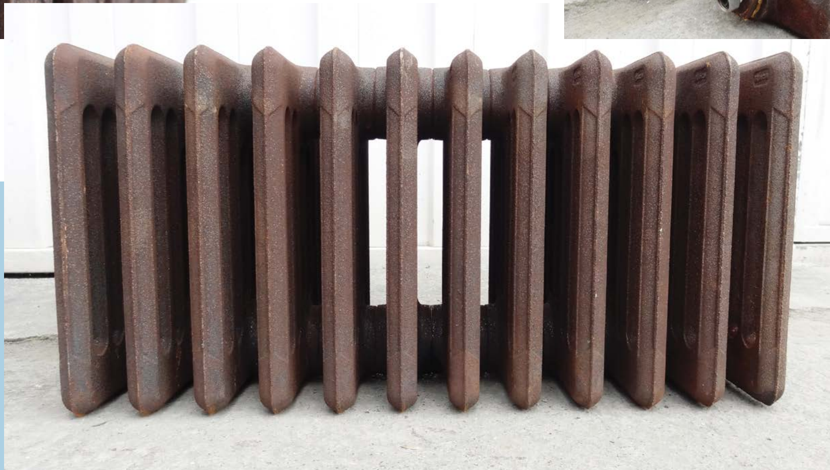
Radiador de hierro fundido decapado por inmersión.
