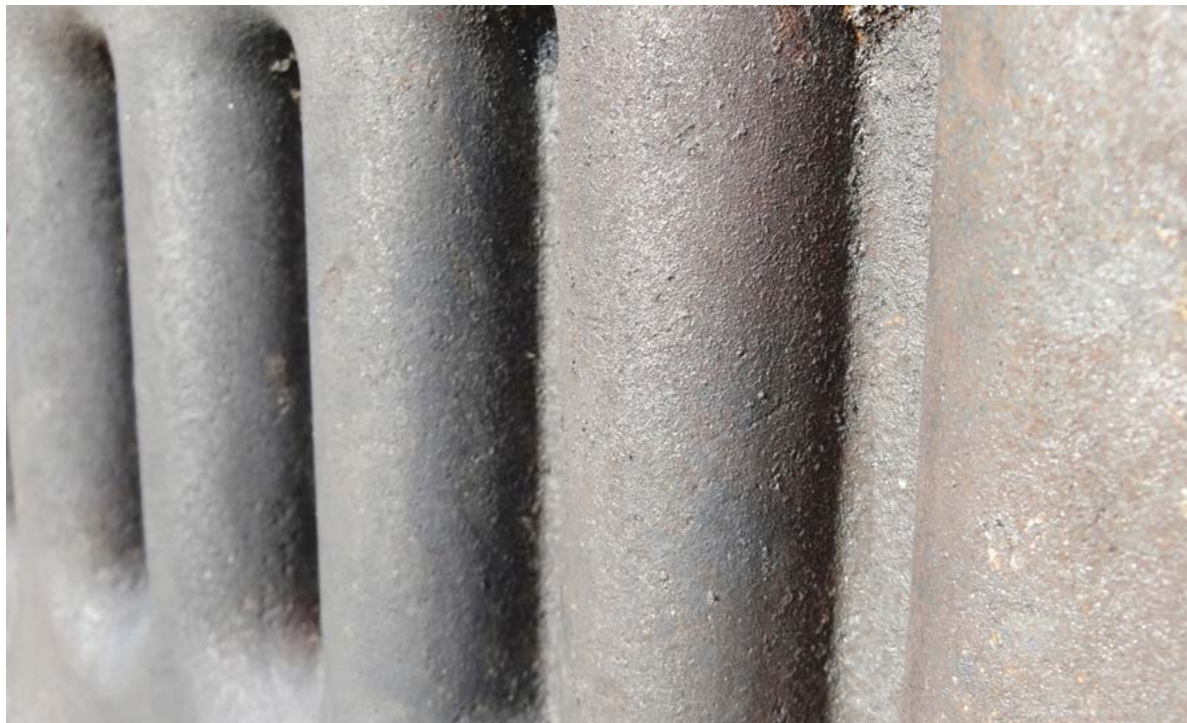
Caldera de hierro fundido decapada por inmersión.
