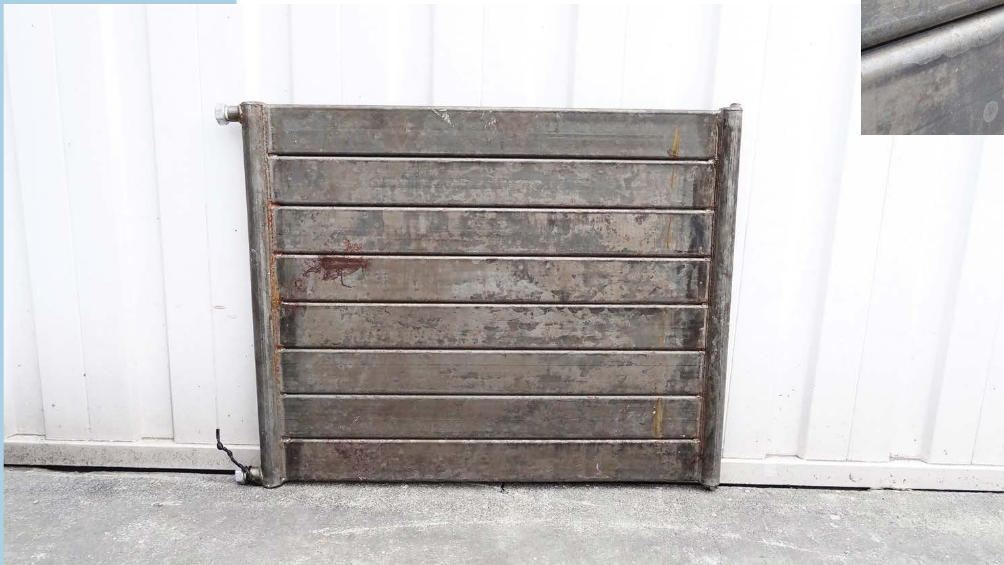
Radidor de chapa decapado por inmersión.
